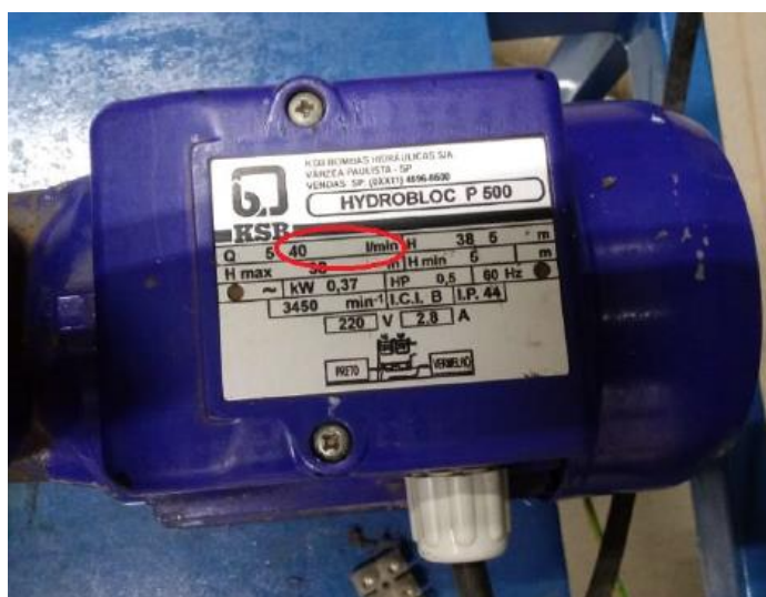
Figura 8: Motobomba de Alimentação de Água Quente.
