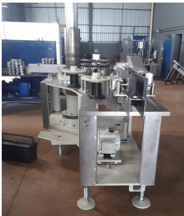
Figura 2 – Parte frontal da enchedora em processo de montagem após revisão
