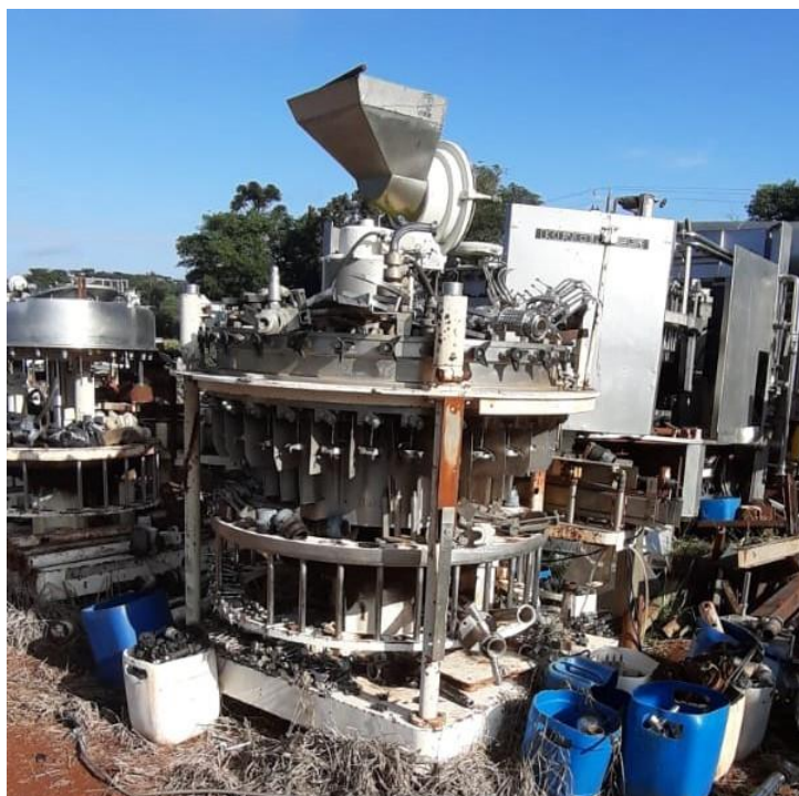
Figura 1 - Parte de uma enchedora quando chega à empresa
