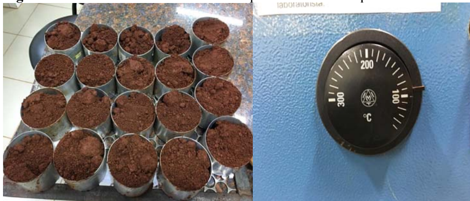
Figura 13: Amostras retiradas da estufa após 24 horas à temperatura de 105°C
