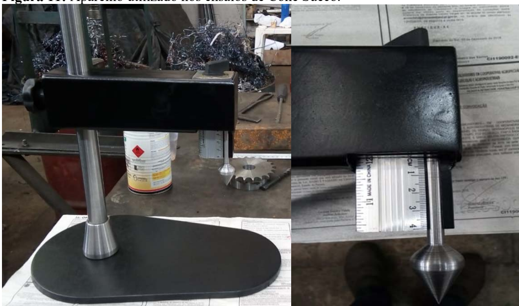
Figura 11: Aparelho utilizado nos ensaios de Cone Sueco.
