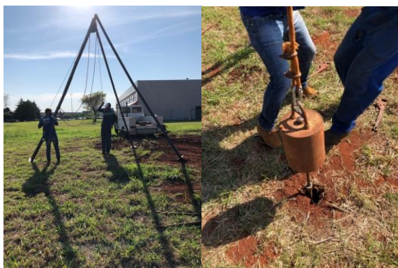
Figura 9: Equipamento para sondagens SPT e martelo ao realizar os golpes
