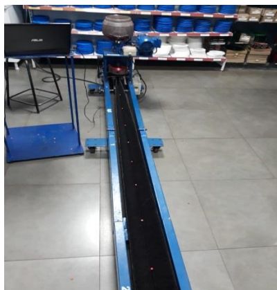
Figura 1 – Esteira de plantabilidade desenvolvida e comercializada pela empresa Scherer.
