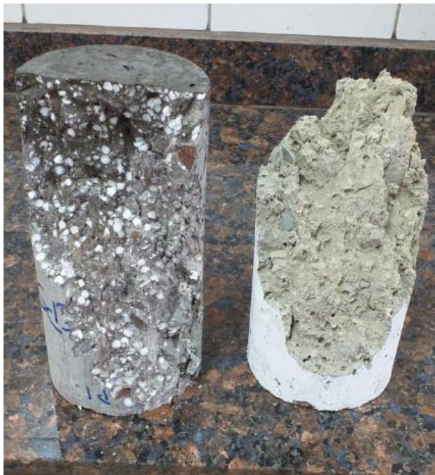
Figura 5: Corpos de prova antes do ensaio de temperatura, à esquerda, e após o ensaio, à direita.
