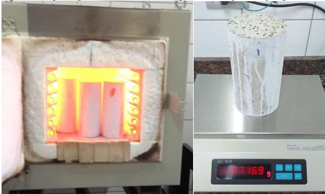
Figura 3: Corpos de prova durante ensaio de temperatura e sua posterior pesagem.
