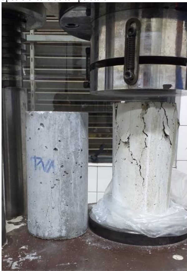
Figura 4: Corpo de prova com 50% EPS + PVA já ensaiado, à esquerda em estado natural e à direita após o ensaio de temperatura
