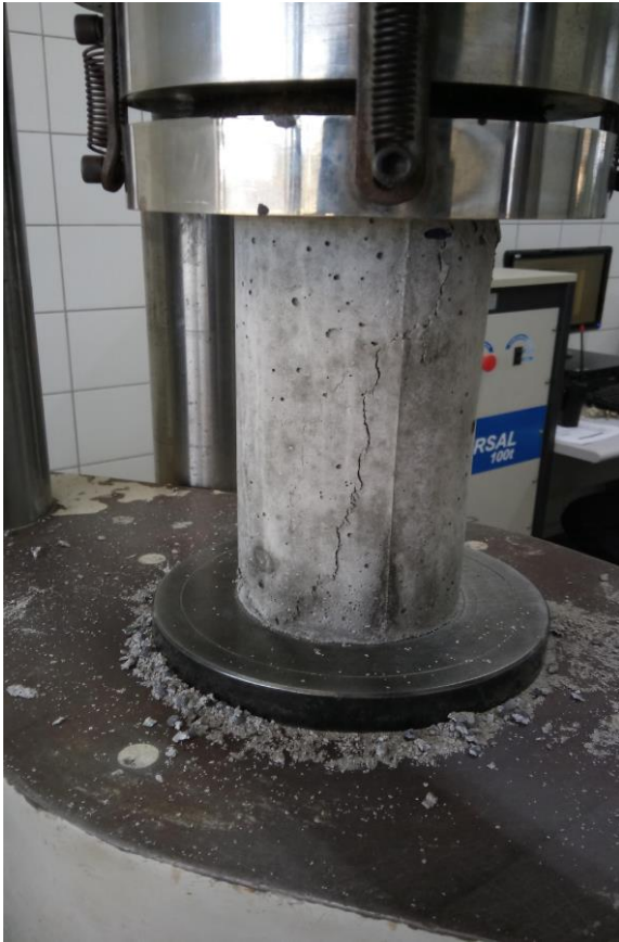
Figura 04: Corpo de prova na prensa hidráulica.
