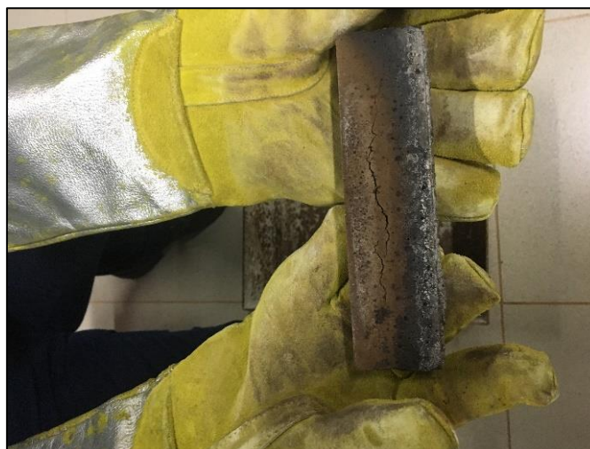
Figura 9 - Corpo de prova prismático após sofrer variação de temperatura com auxílio do forno mufla.
