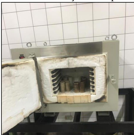
Figura 5 - Corpos de prova sofrendo variação de temperatura com auxílio do mufla.
