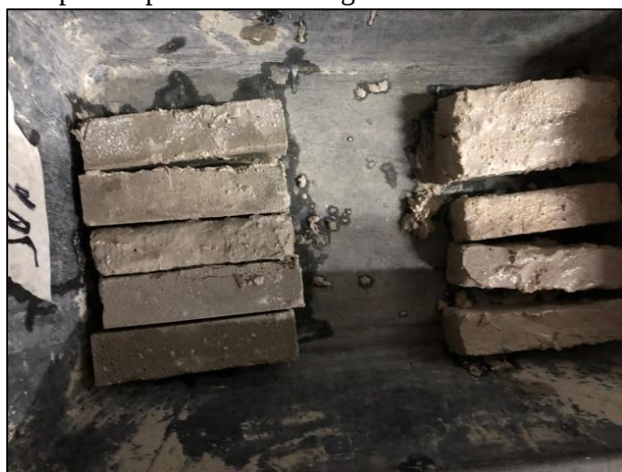
Figura 9 - Corpos de prova após imersão na água com 05% e 07% de adição de açúcar.
