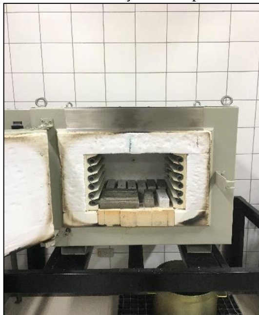
Figura 4 - Corpos de prova sofrendo variação de temperatura com auxílio do forno mufla.
