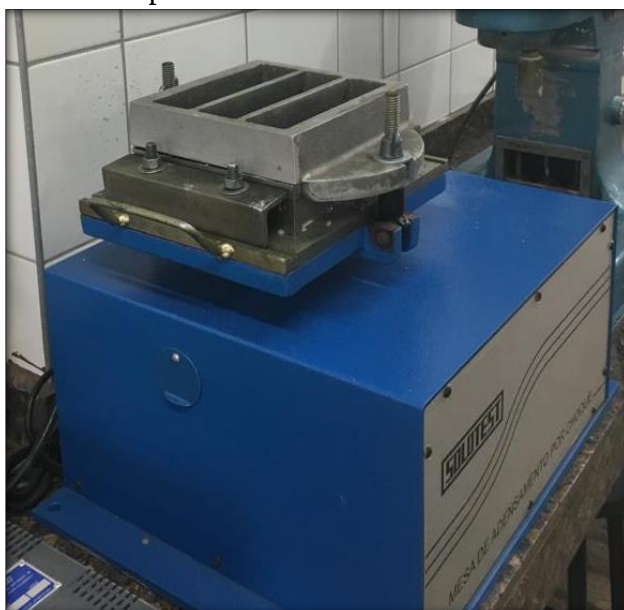
Figura 2 – Molde prismático sobre a mesa de adensamento
