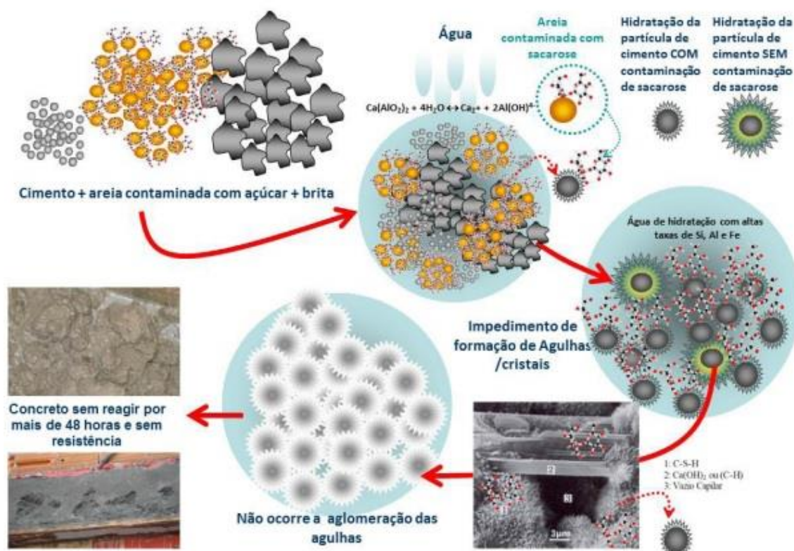
Figura 8 - Processo de hidratação do cimento interrompido pelo açúcar.
