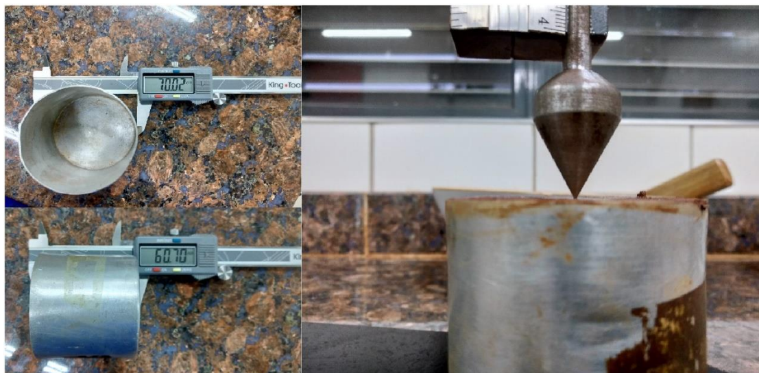
Figura 9: Capsula de ensaio e aparelho configurado.
