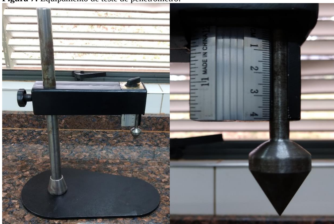
Figura 7: Equipamento de teste de penetrometro.
