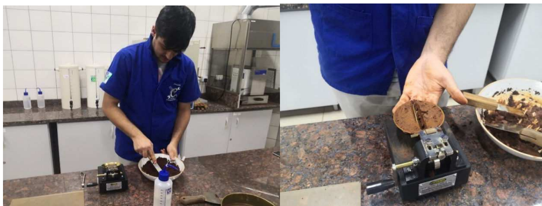
Figura 5: Ensaio de limite de liquidez (LL).
