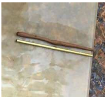
Figura 5: Ensaio de limite de plasticidade (LP).
