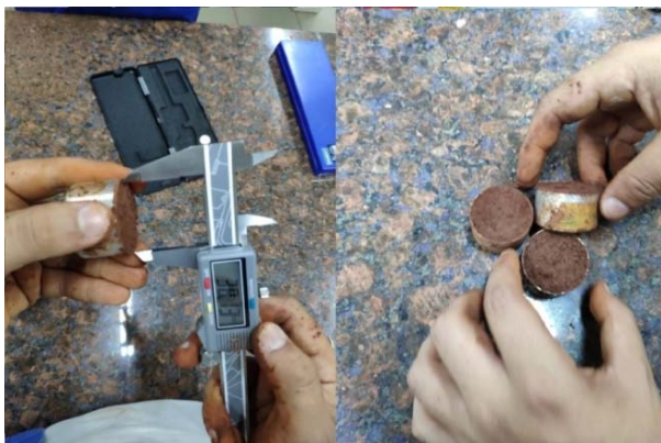
Figura 09: Realização do ensaio para comprovação do \gamma_d pelo \gamma_n
