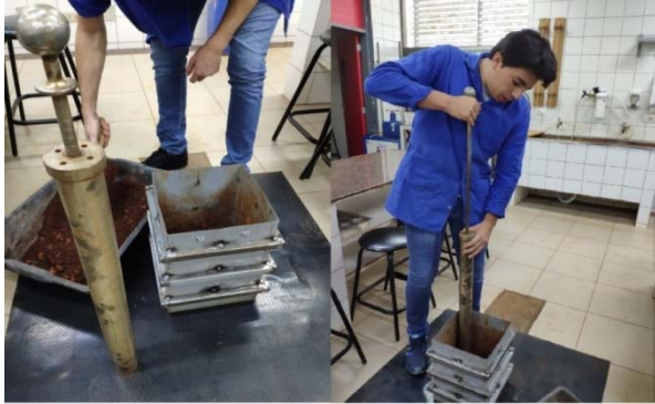
Figura 8: Caixa de aço e realização da compactação.
