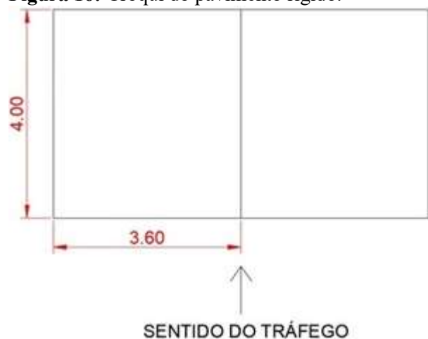
Figura 16: Croqui do pavimento rígido.
