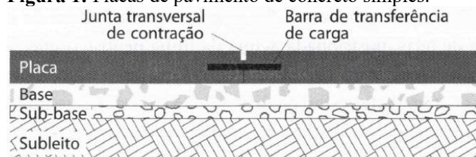
Figura 1: Placas de pavimento de concreto simples.
