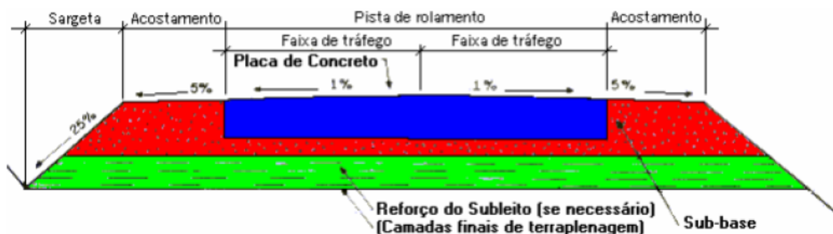
Figura 2 – Seção transversal típica de pavimento rígido
