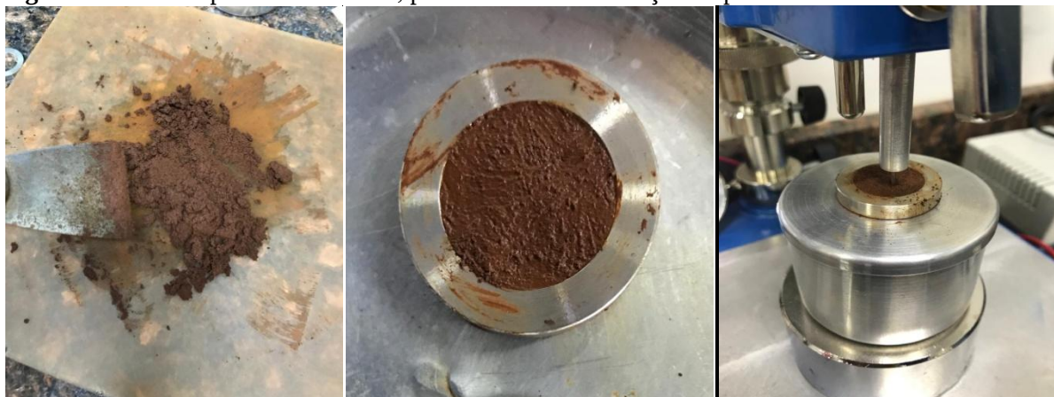
Figura 12: Solo na placa esmerilhada, pastilha de solo e medição no penetrômetro.
