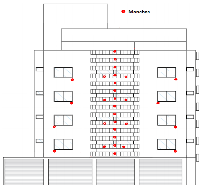
Figura 10: Mapeamento das manifestações patológicas da fachada oeste.
