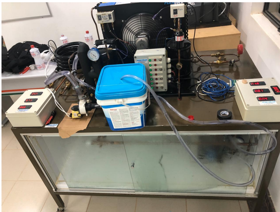
Figura 15: Bancada com o sistema de degelo.
