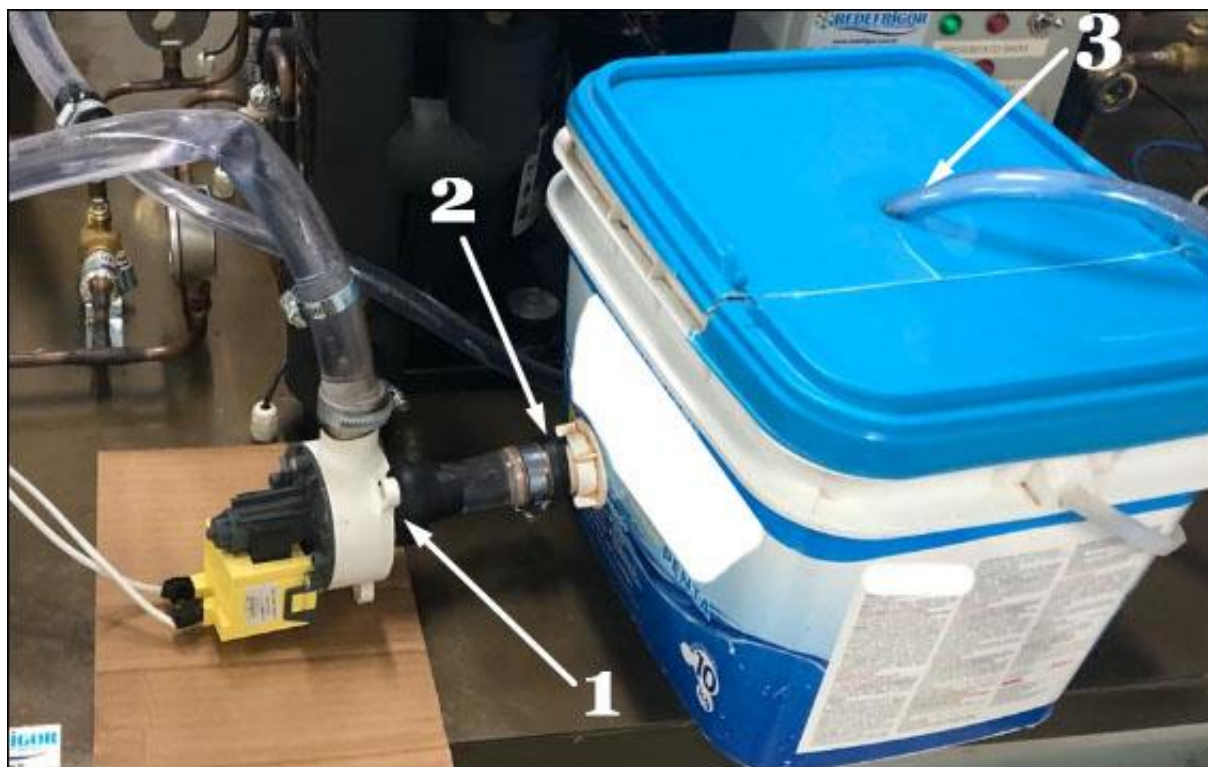
Figura 16: Disposição do reservatório no sistema de degelo.
