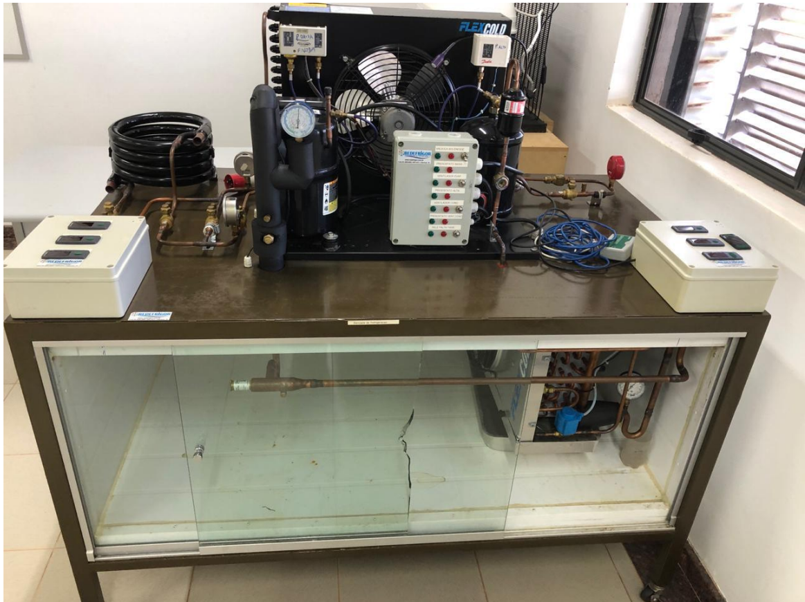
Figura 14: Bancada sem o sistema de degelo.
