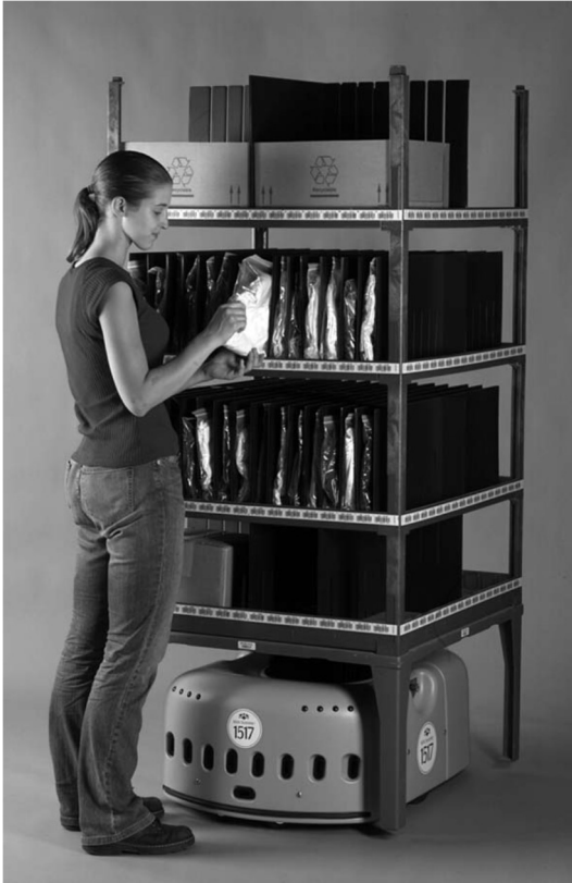
Figura 2 – Robô Kiva e prateleira de armazenamento. Fonte: WURMAN, D'ANDREA e MOUNTZ, 2008
