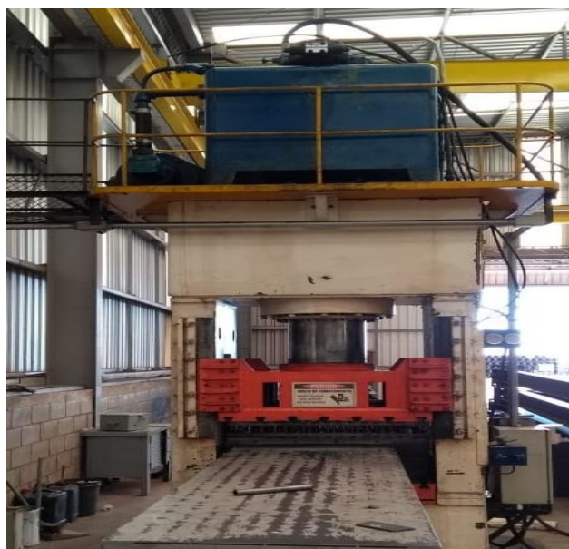
Figura 9: Prensa Hidráulica com capacidade para 250 toneladas
