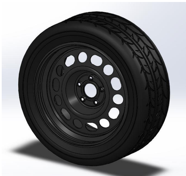
Figura 7: Roda aro 14 VW 4X100 modelo padrão com pneu
