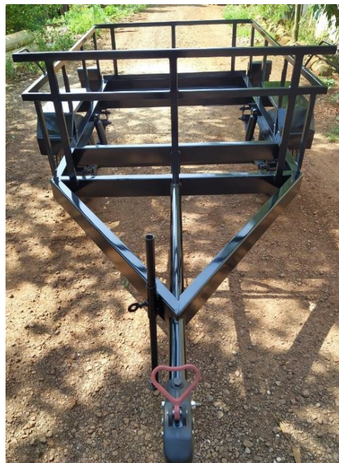
Figura 19: Fixadores e estrutura superior parcialmente montada
