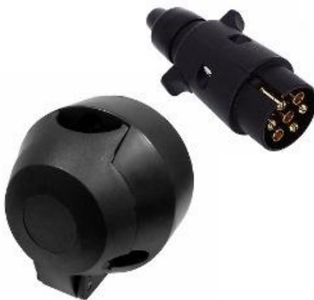
Figura 6: Tomada de ligação do reboque ao veículo trator
