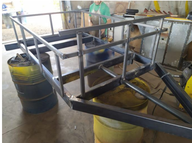
Figura 18: Estrutura-base do reboque montada
