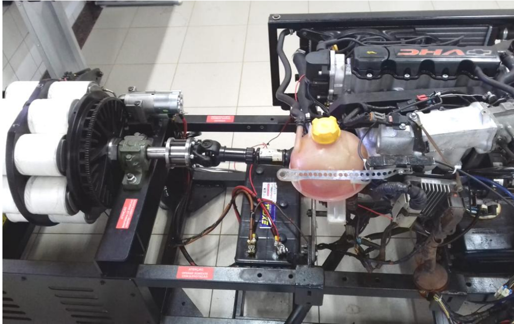
Figura 3 : Motor acoplado ao freio do dinamômetro (Fonte: Elaborado pelo autor, 2019)
