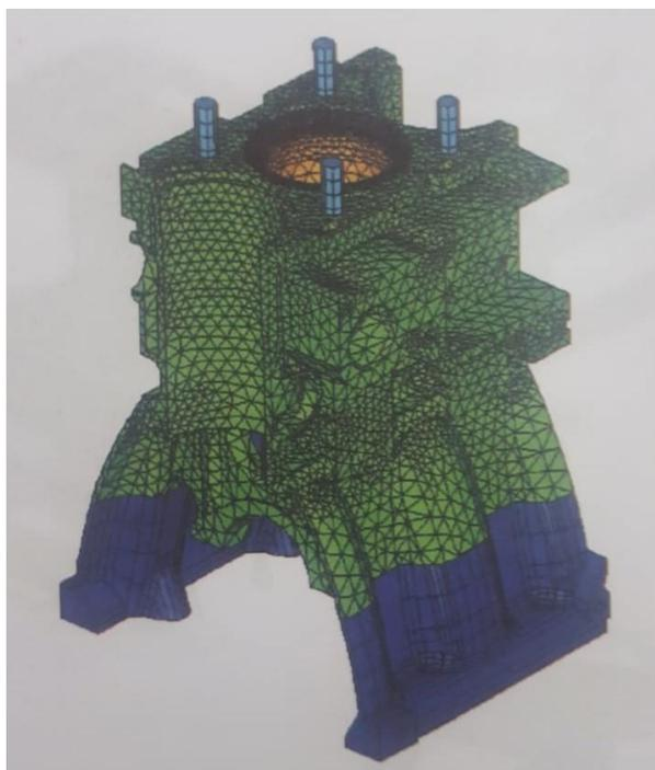
**Figura 9:** Modelo em Elementos Finitos para análise de região de bloco de motor
