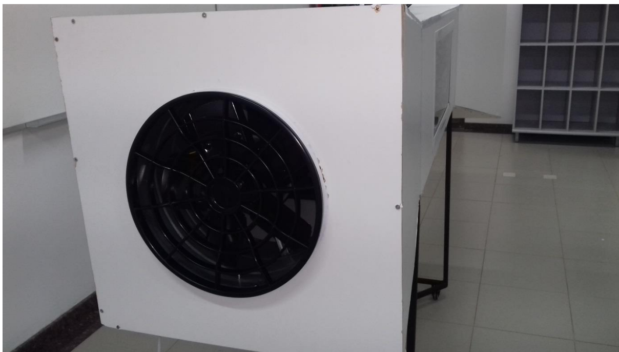
Figura 12- Suporte traseiro com exaustor instalado
