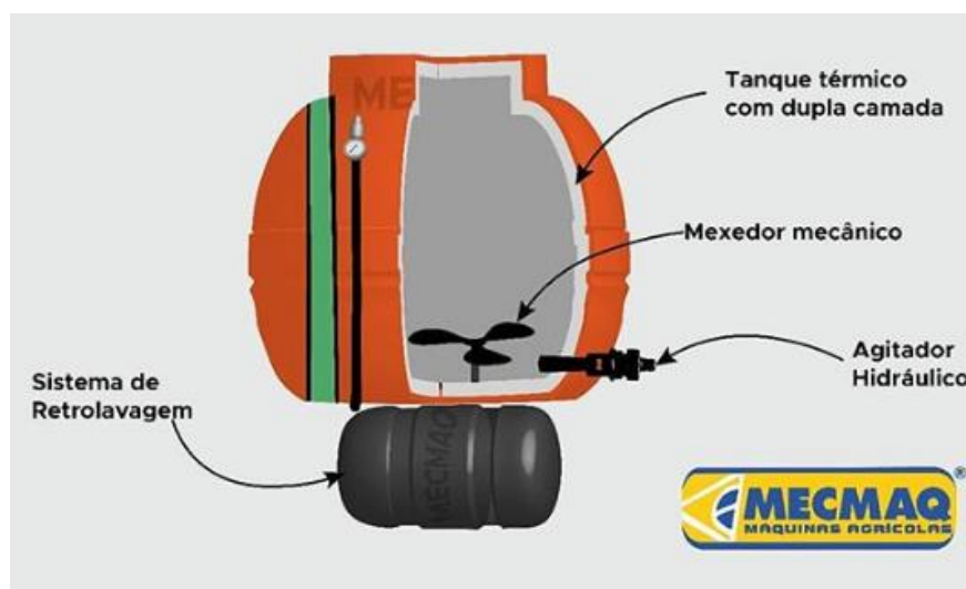
Figura 2: Esquema estrutural do tanque
