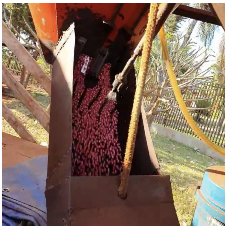
Figura 39: Teste Para Averiguação da Inclinação Adequada (30°)
