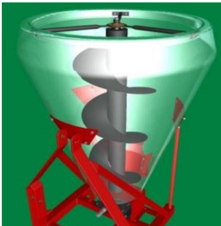
Figura 21: Rosca Helicoidal Interna do Reservatório
