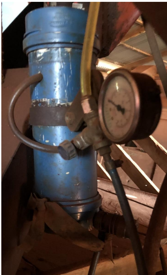
Figura 62: Reservatório do Inoculante
