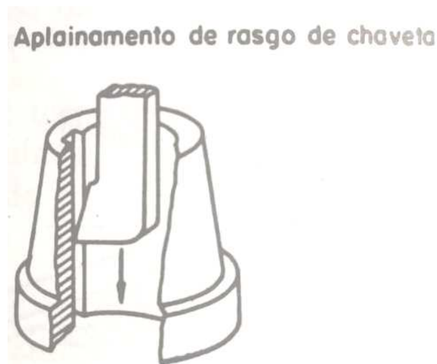
Figura 2: Aplainamento de rasco de chaveta
