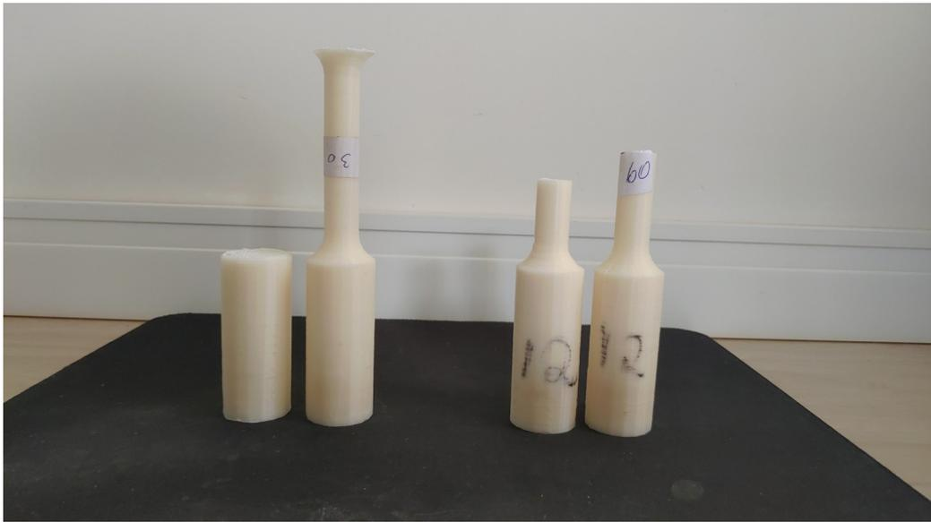
**Figura 28:** Corpos de prova após ruptura no ensaio de tração
