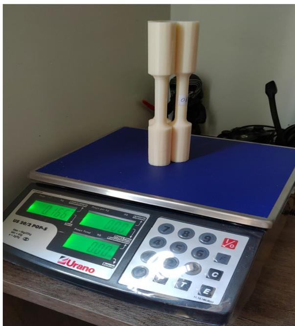
**Figura 23:** Avaliação das massas dos corpos de prova utilizando balança
