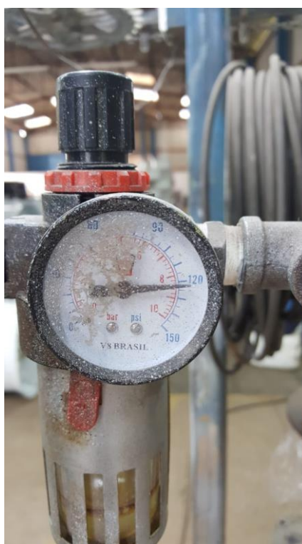
Figura 9: Manômetro com perda de carga FONTE: O AUTOR (2019)
