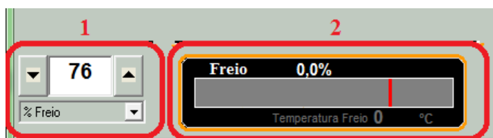
Figura 10 – Configuração do freio eletromagnético, (1) controle de freio e (2) mostrador de frenagem.
