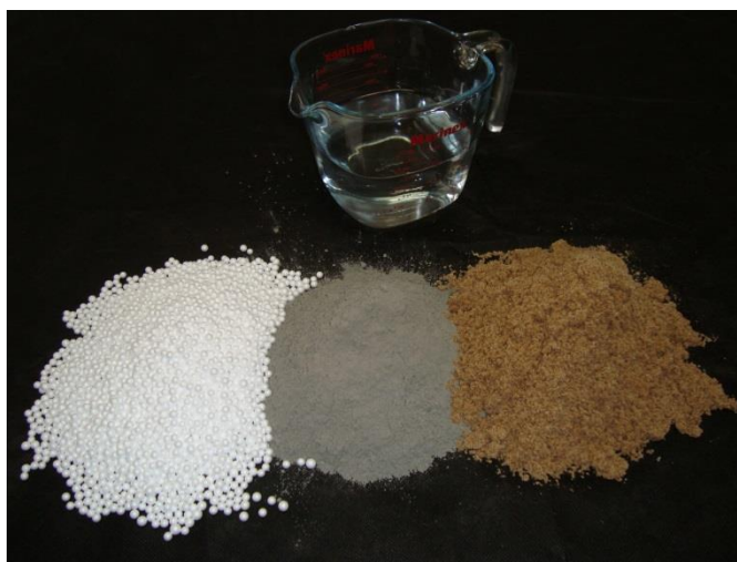
Figura 6 - Mistura para o concreto leve (Flocos de EPS, cimento, areia e água)
