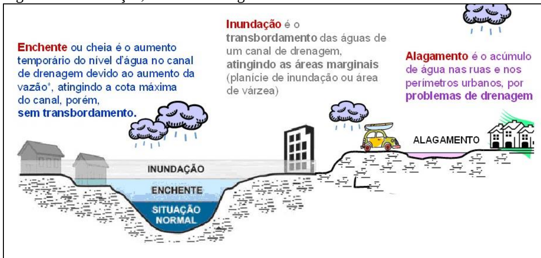
Figura 10 - Inundação, enchente e alagamento
