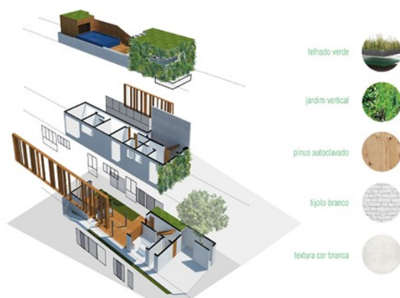
FIGURA 29: Materiais Utilizados Casa HLC
