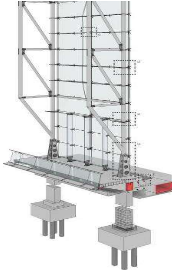
Figura 21 - Esquema treliça de suporte a pele de vidro
