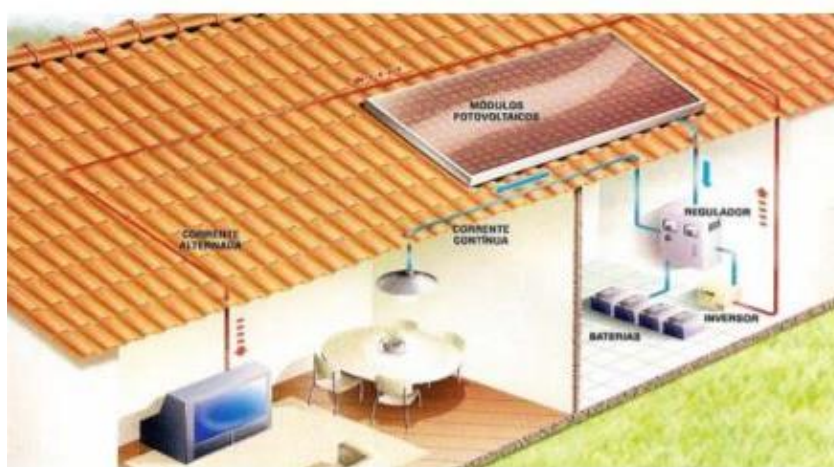
Figura 5 – Sistema de energia solar fotovoltaica.
