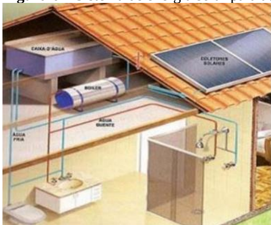
Figura 6 – Sistema de energia solar para aquecimento de água.
