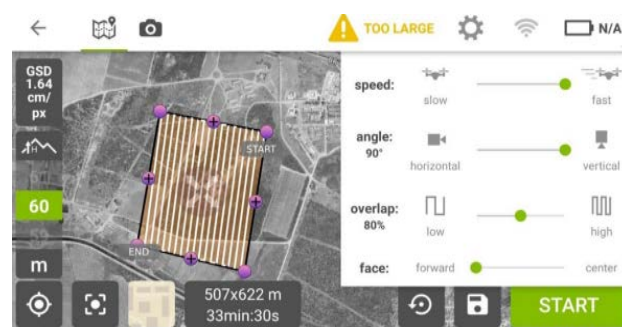
Figura 5 - Configurações para controlar o drone - PIX4D
