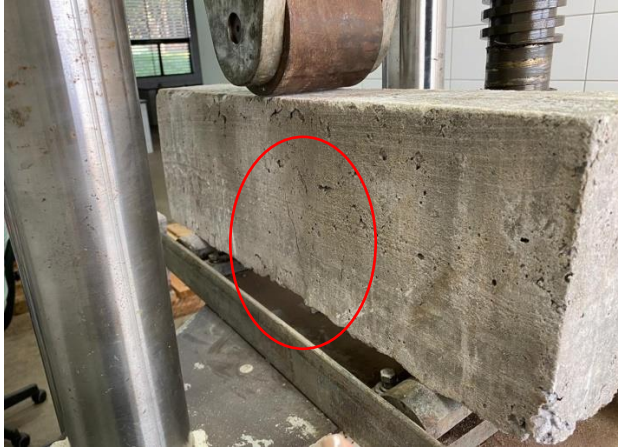
Figura 9: Comportamento de ruptura da viga com aço estrutural.
