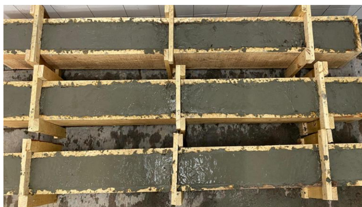
Figura 2: Vigas de concreto.
