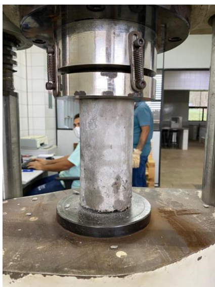
Figura 6: Ensaio de resistência à compressão.
