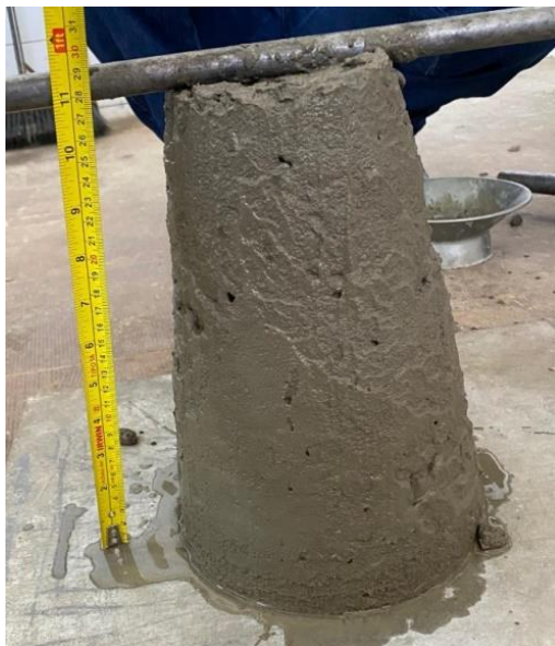
Figura 4: Controle da consistência do concreto.
