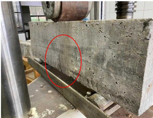
Figura 10: Comportamento de ruptura da viga com a100% de fibra de aço.
