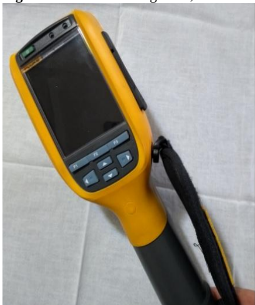
Figura 32 Câmera termográfica, Fluke ti 110
