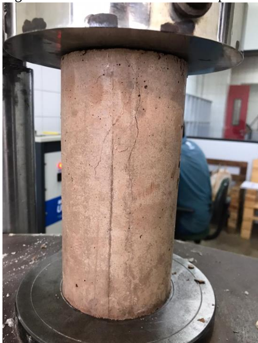
Figura 3: Ensaio de resistência à compressão
