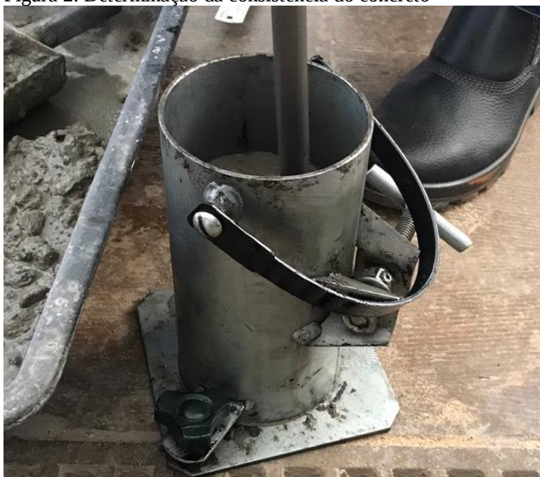
Figura 2: Determinação da consistência do concreto
