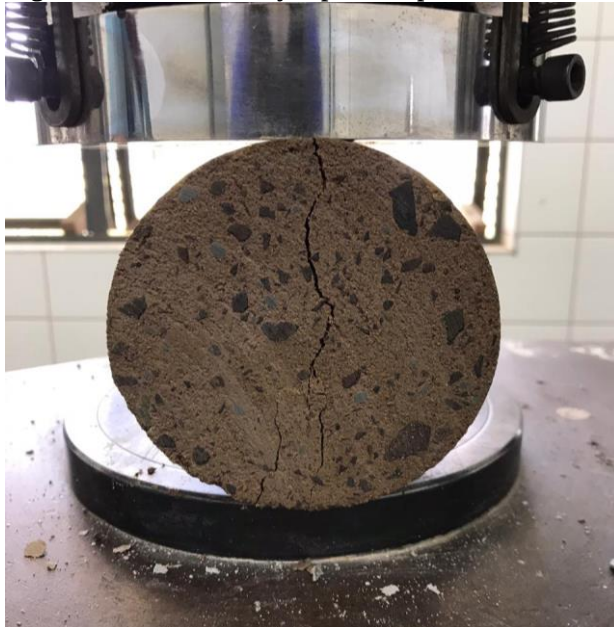
Figura 4: Ensaio de tração por compressão diametral
