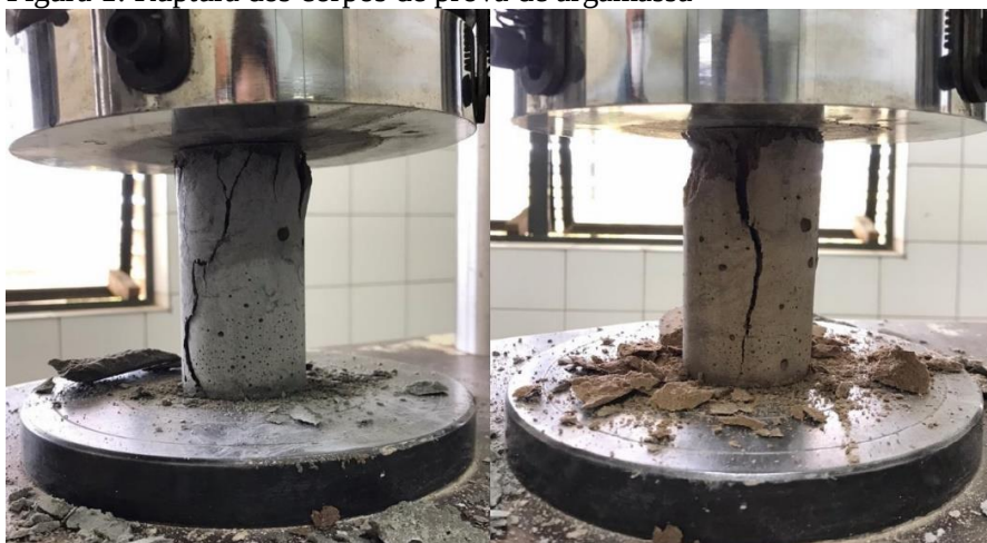
Figura 1: Ruptura dos corpos de prova de argamassa
