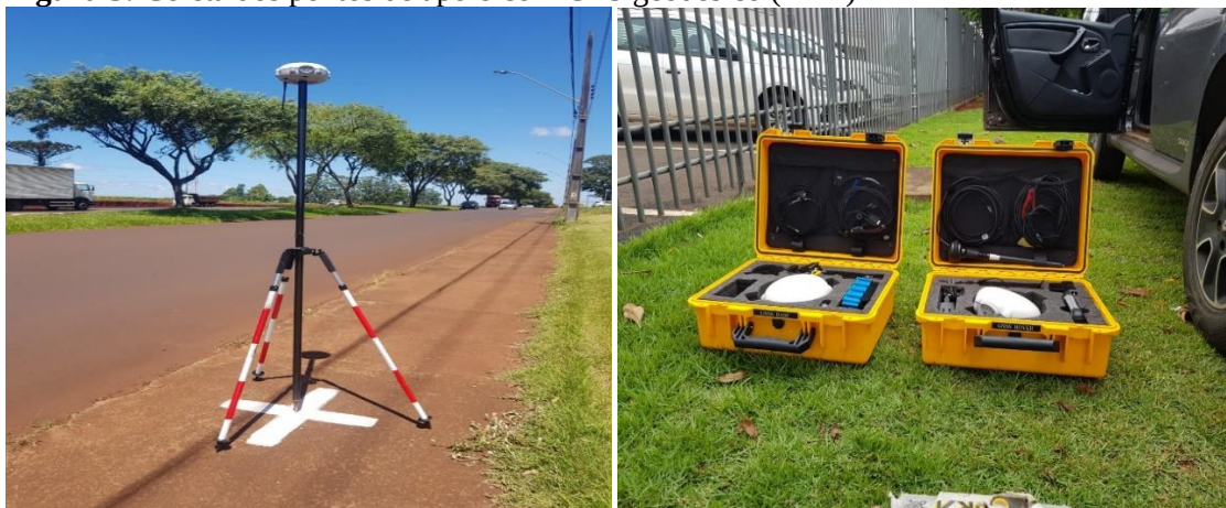
Figura 5: Coleta dos pontos de apoio com GPS geodésico (RTK)
