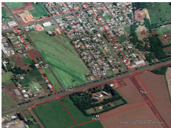
Figura 4: Distribuição dos pontos de controle e pontos de verificação.
