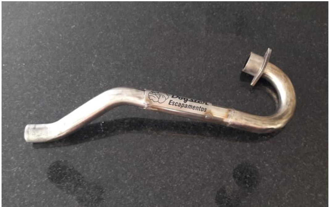
Figura 11: Parte anterior do tubo principal do escape.
