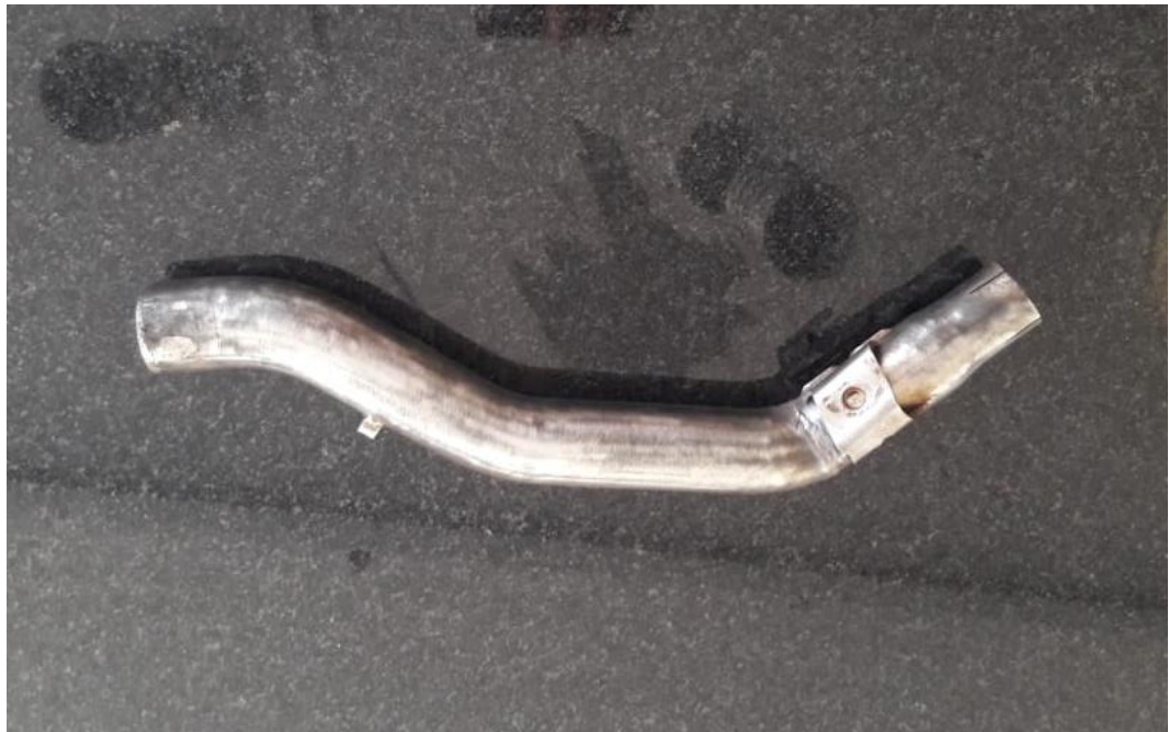
Figura 12: Parte posterior do tubo principal do escape.
