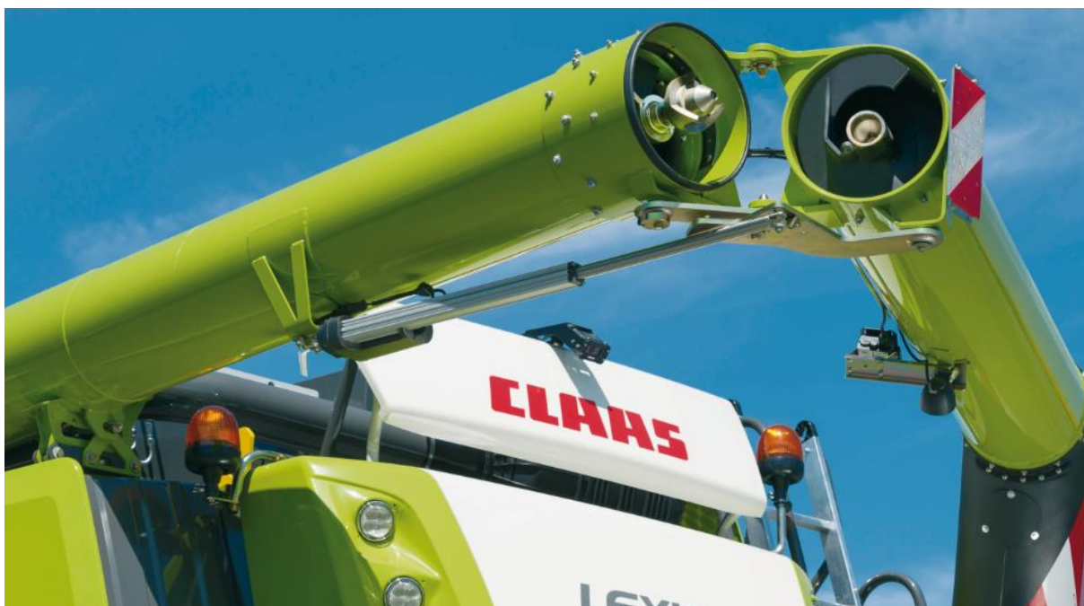
Figura 5: rosca transportadora com atuador elétrico na articulação
