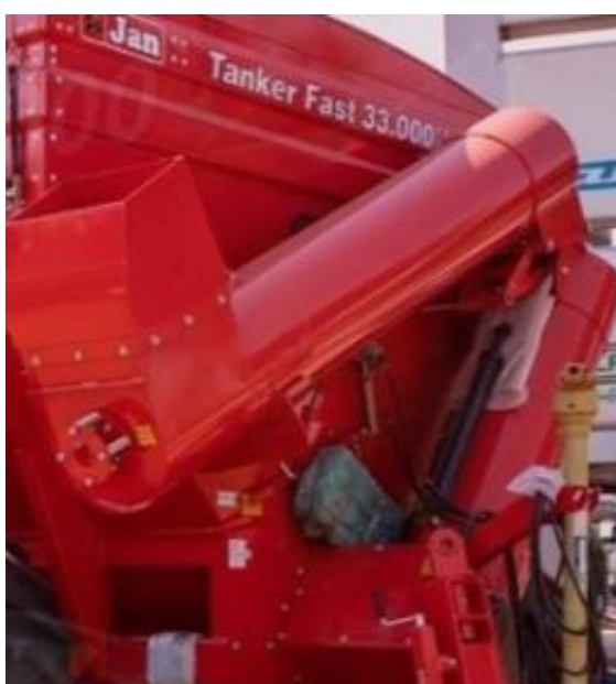
Figura 4: Rosca transportadora com atuador hidráulico na articulação
