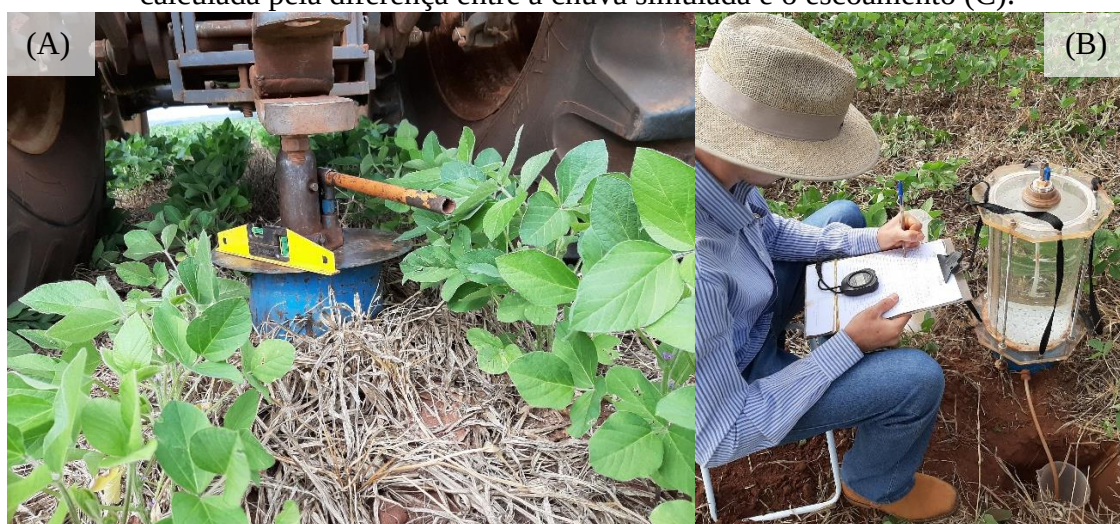
Figura 3 - Fixação de anel metálico (limitador da área de captação da chuva simulada), com auxílio de trator e macaco hidráulico (A); realização da leitura do Infiltrômetro de Cornell conforme tempo estipulado (B); curva de infiltração de água no solo calculada pela diferença entre a chuva simulada e o escoamento (C).
