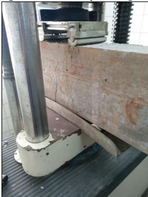
Figura 6 – Detalhe da ruptura da viga V2.
