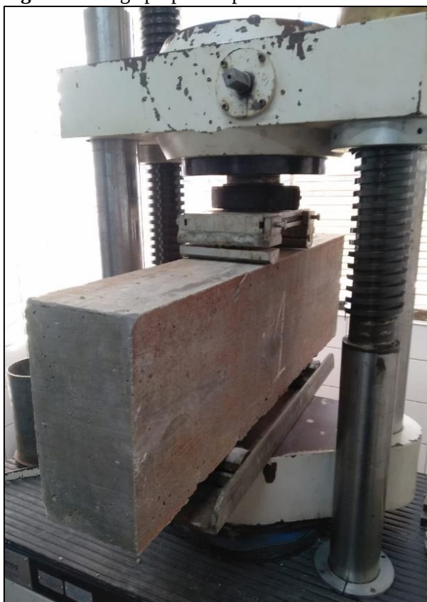
Figura 4 – Viga preparada para o teste de flexão de 4 pontos.
