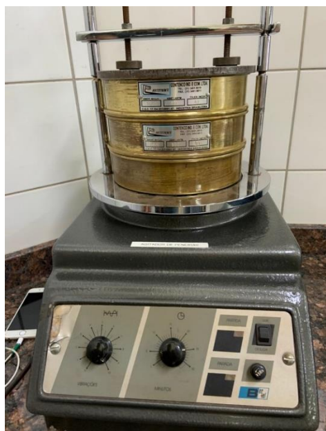
Figura 7 – Agitador realizando o peneiramento da areia.
