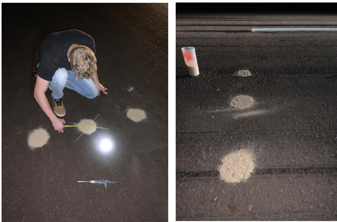
Figura 11 – Ensaios realizados em cada área e desgaste no pavimento asfáltico.
