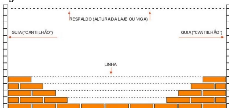
Figura 7: Assentamento da alvenaria.
