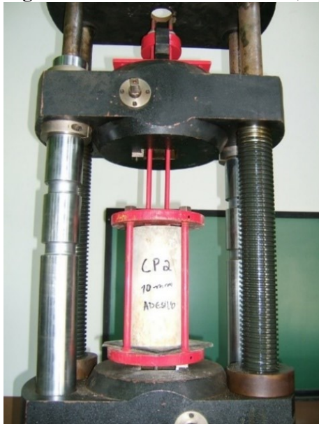
Figura 11: Ensaio de arrancamento, aço 10,0mm com adesivo.
