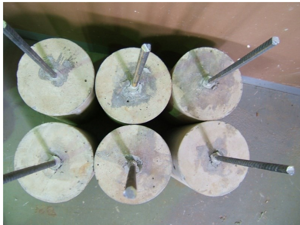
Figura 14 - Grupo de CPs com vergalhão 3/8", solidarizados com adesivo.
