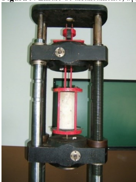
Figura 9: Ensaio de arrancamento, aço 10,0mm.
