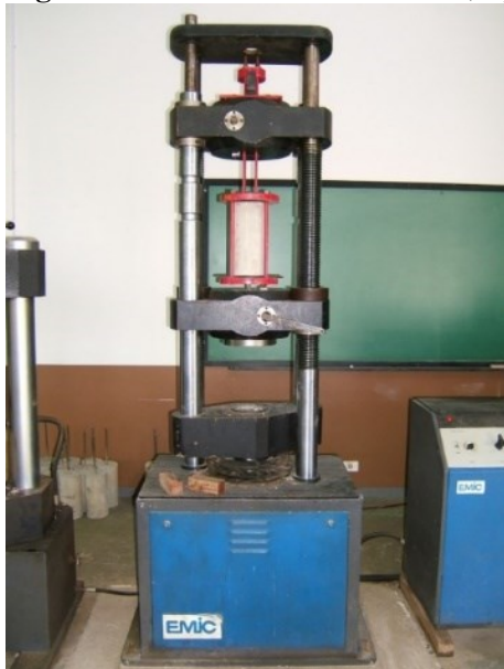
Figura 10: Ensaio de arrancamento, aço 12,5mm.
