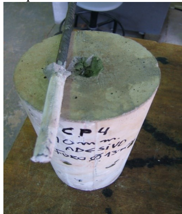
Figura 15 - CP 3/8" com adesivo, rompimento do concreto na interface.
