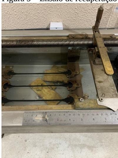
Figura 5 – Ensaio de recuperação elástica.
