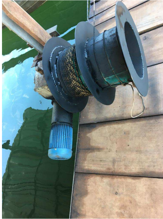
Figura 47: Sistema de transmissão do motor de avanço.
