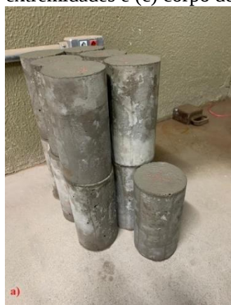
Figura 03: Procedimentos realizados: (a) corpos de prova após a retirada da cura, (b) capeamento de extremidades e (c) corpo de prova rompido
