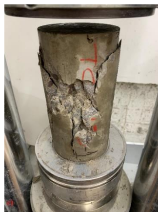
Figura 03: Procedimentos realizados: (a) corpos de prova após a retirada da cura, (b) capeamento de extremidades e (c) corpo de prova rompido
