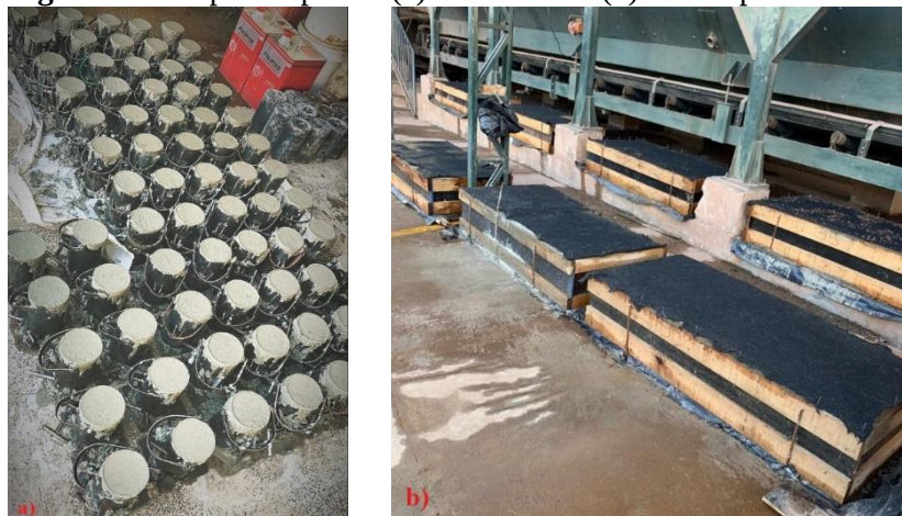
Figura 01: Corpos de prova: (a) cilíndricos e (b) blocos prismáticos
