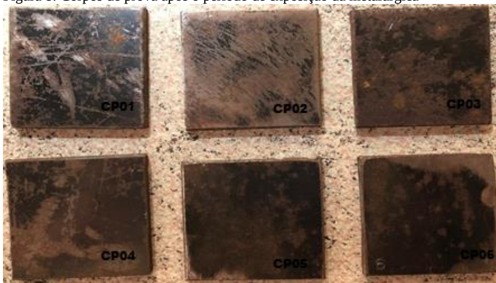
Figura 8: Corpos de prova após o período de exposição da metalúrgica
