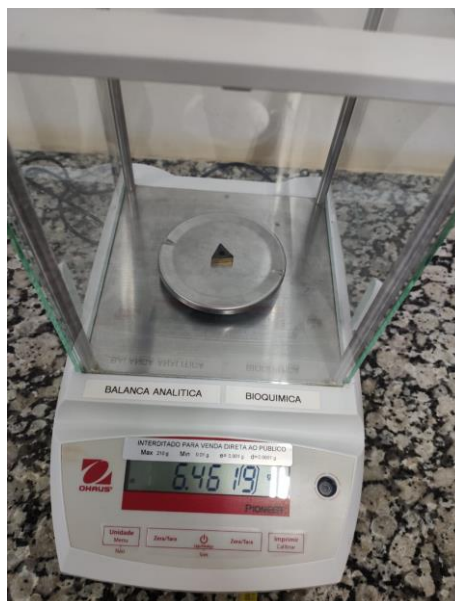
Figura 17: Pesagem da pastilha “B” da Sandvik
