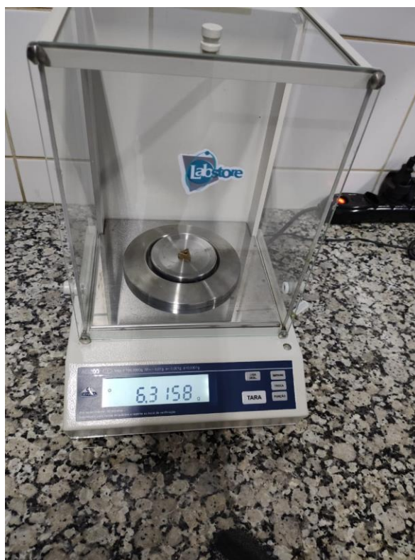
Figura 33: Pesagem da pastilha “B2” da Taegutec depois do desgaste
