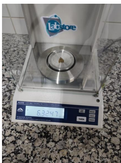
Figura 18: Pesagem da pastilha “A2” da Taegutec
