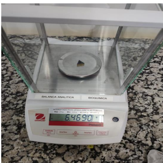
Figura 16: Pesagem da pastilha “A” da Sandvik
