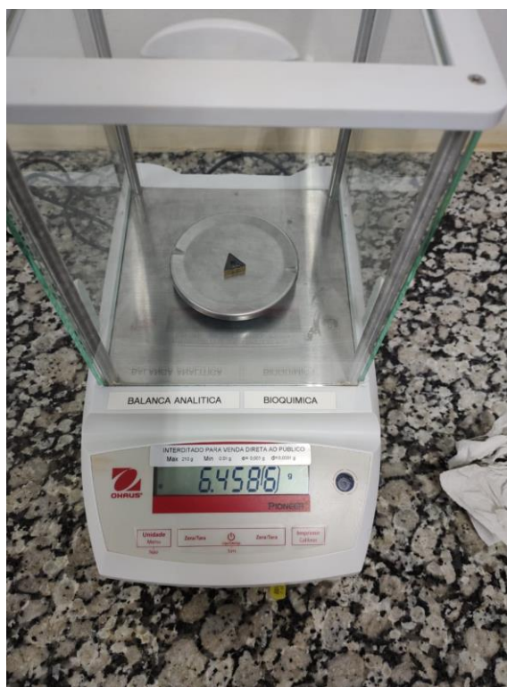
Figura 27: Pesagem da pastilha “A” da Sandvik depois do desgaste
