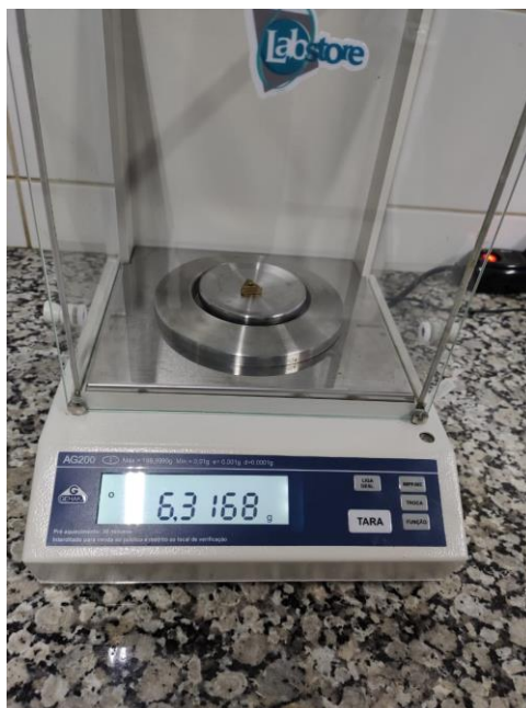
Figura 19: Pesagem da pastilha “B2” da Taegutec
