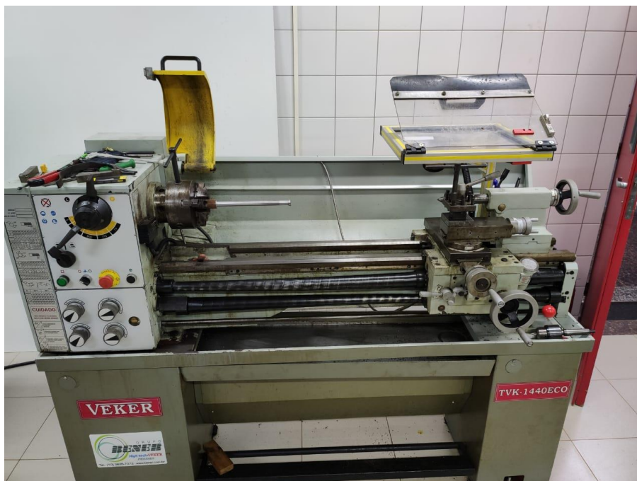
Figura 7: Torno convencional da marca Veker modelo TVK– 1440ECO
