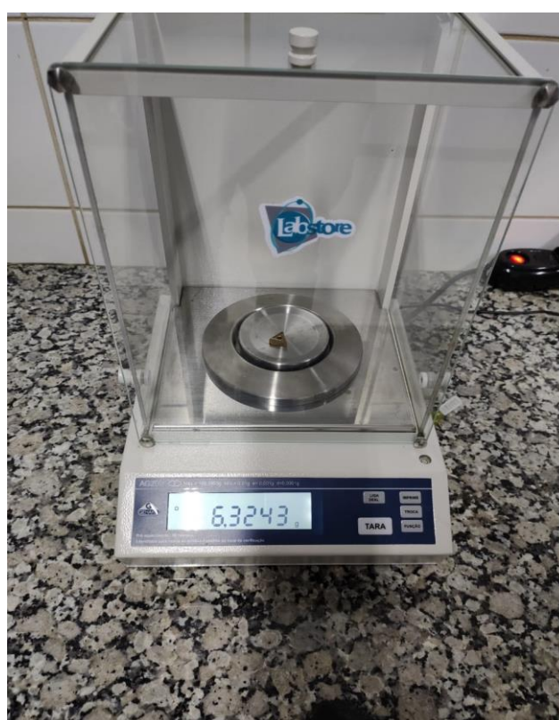
Figura 29: Pesagem da pastilha “A2” da Taegutec depois do desgaste
