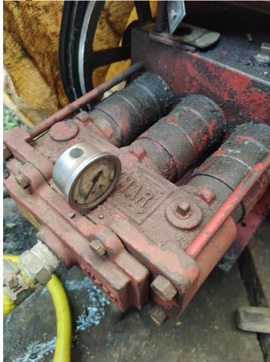
Figura 24 - Bomba Hidromar BH6100
